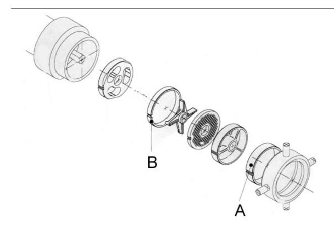
Режущий механизм состоит из подпорной решетки (В), выходной ножевой решетки ножа, промежуточной и приемной решеток (А).
