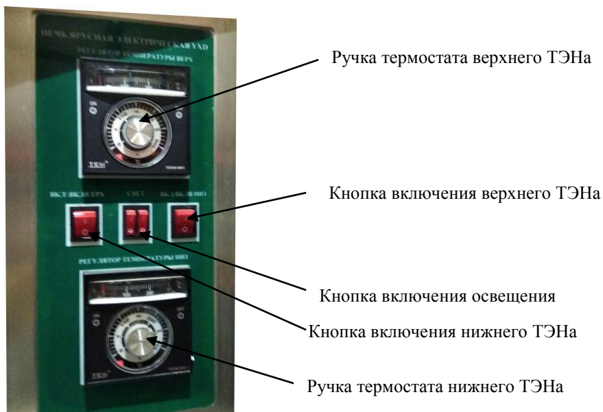
Рис3 – обозначения блока управления печью.
